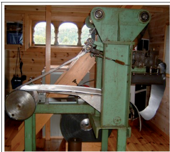
Verdens første spolemaskin for aluminiums-rotorer som vist ovenfor. Første konkurrent kom på markedet etter 4 års tid, og forlengst for mange år siden har aluminiums-rotorer blitt tatt i bruk til varmegjenvinning over hele verden.
