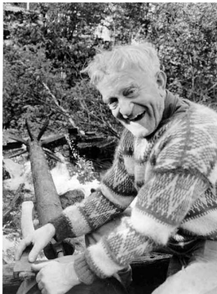
Theodor Løvbrekke kvesser øksa på slipestein med vassdrift.
