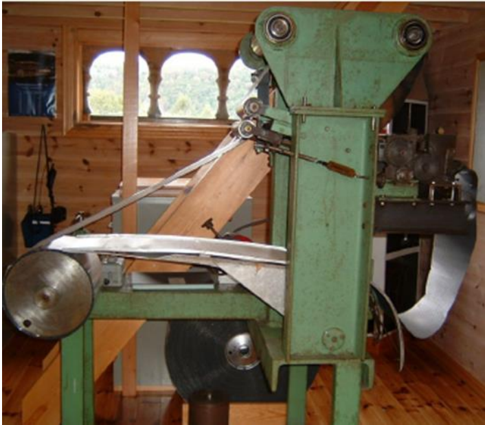
Verdens første spolemaskin for aluminiums-rotorer. Første konkurrent kom på markedet etter 4 år, og for lengst for mange år siden, har aluminiums-rotorer blitt tatt i bruk til varmegjenvinning over hele verden. Maskinen oppbevares i bedriftsmuseet på Aaland Gård, Oremo i Bjerkreim.
